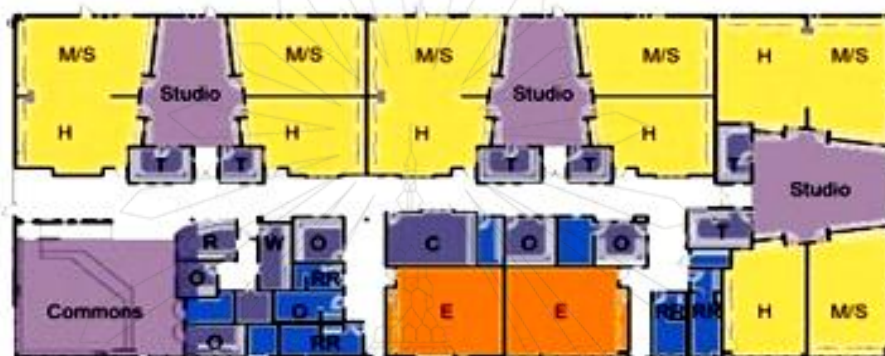
แผนภาพที่ 2.22 แผนผังอาคารที่ High tech middle แสดงมีการจัดในลักษณะเป็นห้องชุด (ห้องเรียนจำนวน 4 ห้องล้อมรอบห้องสตูดิโอสำหรับทำงาน)
